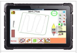
3 Как только съемка завершена, вы сразу можете видеть отметки земли (зоны среза и наполнения).
